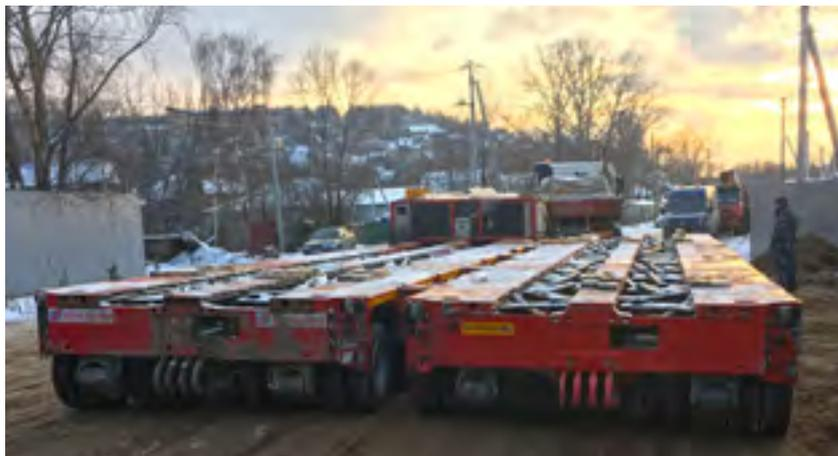
**Фото 4.** Спаренные тележки на специально построенном причале для разгрузки баржи
