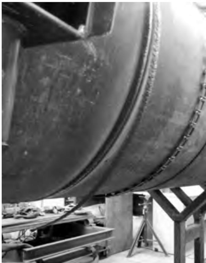
**Рис. 11** Вид кольцевого сварного шва с самоотделяющейся в процессе автоматизированной сварки шлаковой коркой
