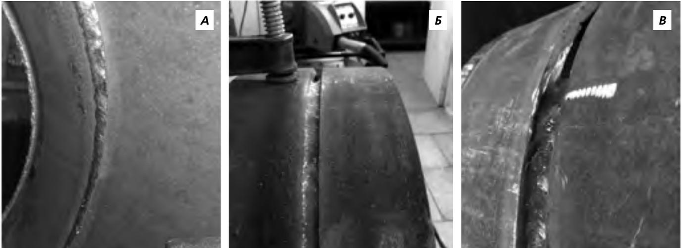
**Рис. 1** Вид сварного шва, выполненного металлопорошковой проволокой
