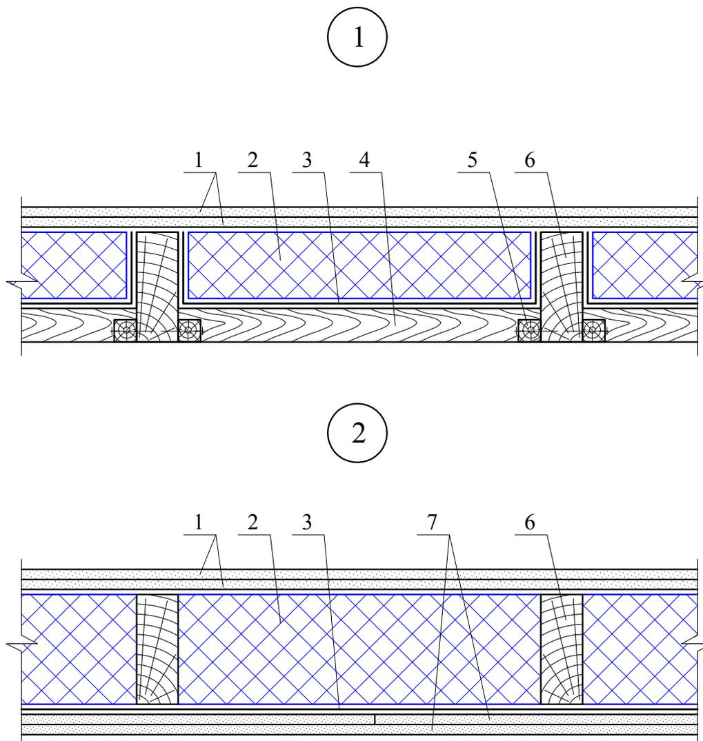
1 - сборная стяжка из двух слоев хризотилцементных или гипсоволокнистых листов; 2 - теплоизоляция из пенополистирольных резаных плит марок ППС10-Р, ППС12-Р, ППС13-Р или ППС14-Р; 3 - пароизоляция; 4 - сплошной деревянный настил; 5 - доборный брус; 6 - балка перекрытия; 7 - обшивка из ГКЛ или ГВЛ
