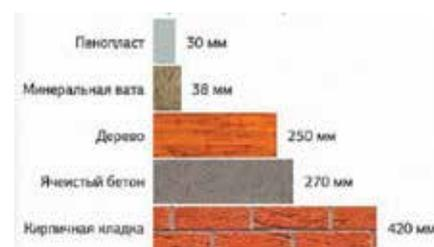
Сравнение толщины слоя пенополистирола (пенопласт), минваты, кирпича, дерева, бетона, необходимой для одинакового уровня утепления.
